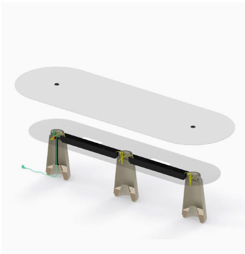
Gestión eléctrica integrada compuesta por una columna electrificada y dos canales de electrificación que conecta las tres columnas. Una de las tres columnas está electrificada con un tubo interior fabricado en acero con un diámetro de 40 mm y atornillado a la parte inferior de la columna. La canal de electrificación está fabricada en chapa de acero plegada con un espesor de 3 mm.
